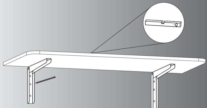
2 - Coloque la mesa en el lugar deseado para la instalación y marque los agujeros. Utilice el nivel para asegurarse de que está nivelada.
