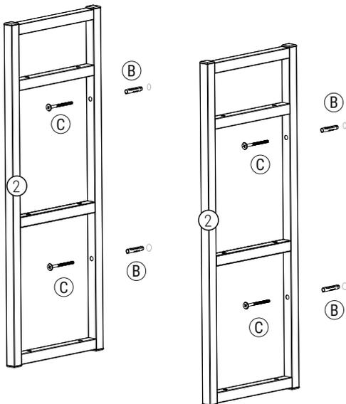
3°. Fixe as prateleiras ① nas travessas ② utilizando os parafusos ①. Pronto, montagem concluída!
