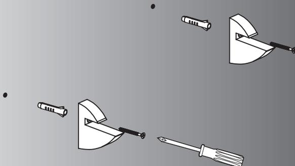
3 - Inserte los bujes en los agujeros y asegure los soportes con los tornillos. Apriete hasta el final con la llave Phillips
