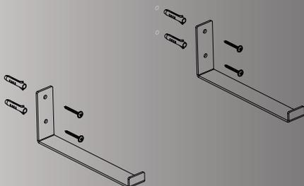
2 - Introducir los casquillos y fijar los soportes con los tornillos.
