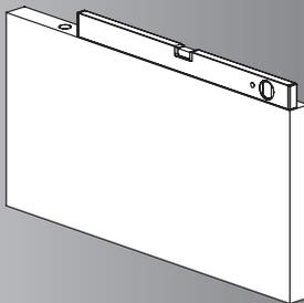
1 - Establezca la ubicación de la instalación. Coloque el repisa en la posición deseada y apoyar el nivel en ella. Asegúrese de que está nivelado.
