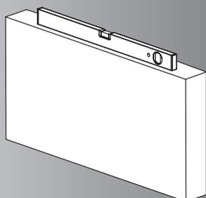
1 - Establezca la ubicación de la instalación. Coloque el repisa en la posición deseada y apoyar el nivel en ella. Asegúrese de que está nivelado.
