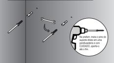
3 - Inserte las bujes en los agujeros y los soportes en las bujes. Apriete hasta el final con la llave 1/4. (Si lo prefiere, inserte el soporte directo en un atornillador y con CUIDADO apriete hasta el final.)
