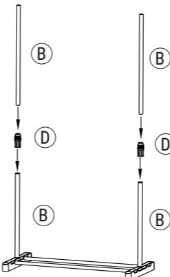
3 - Utilizando las conexiones **D**, fije los travesaños **B** a los travesaños **B** ya fijados a la base **A**.
