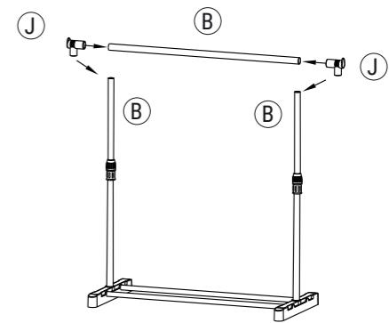
4 - Utilice las conexiones **J** para fijar el último travesaño **B** a los demás.
