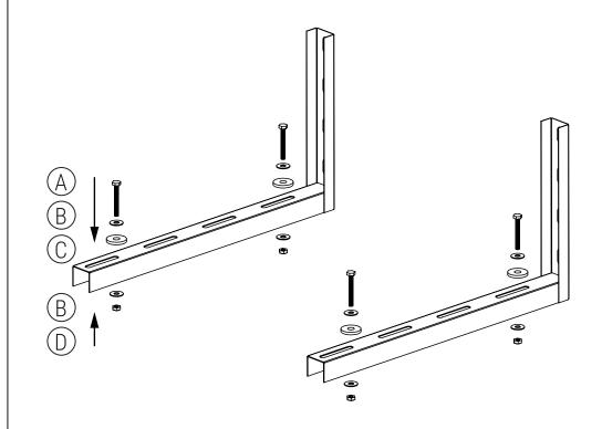
1°. Para fijar el aire acondicionado al soporte utilice los tornillos.
