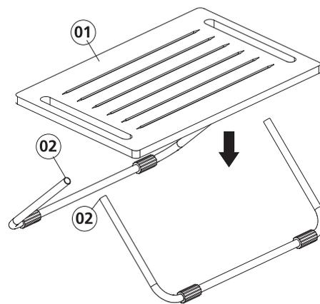
3º Insira as conexões (B) nas bases em aço nº 2 para fixar o apoio.
