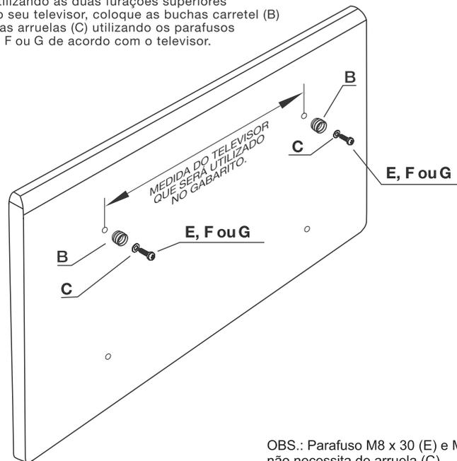
OBS.: Parafuso M8 x 30 (E) e M6 x 25 (F) não necessita de arruela (C).
